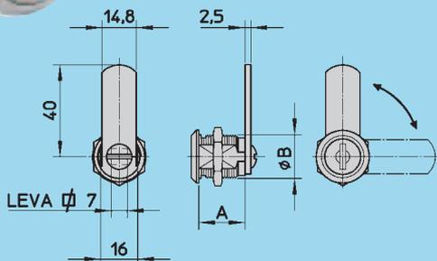
Serratura a 5 lamelle, corpo in zama cromata
